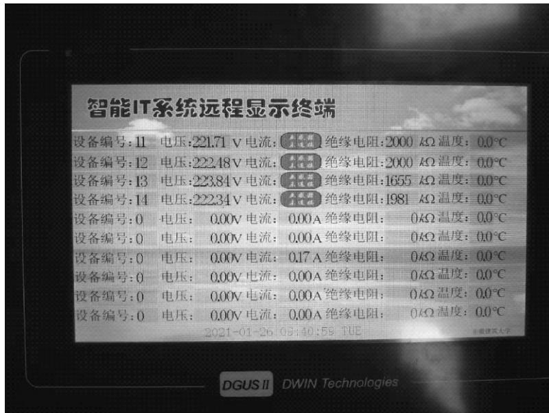
1、液晶屏尺寸: 7 寸, 分辨率: 800\*480 电阻触摸
