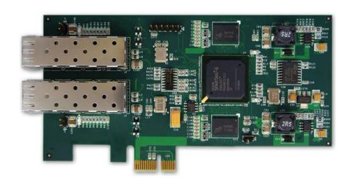
SFP28-MCB 单板全部走微带线,无打孔,阻抗设计控制单端 50 欧姆,包含 2 倍校准线。采用可拆卸高速 SMA 接头与仪器连接(最大带宽支持 60Ghz)。
