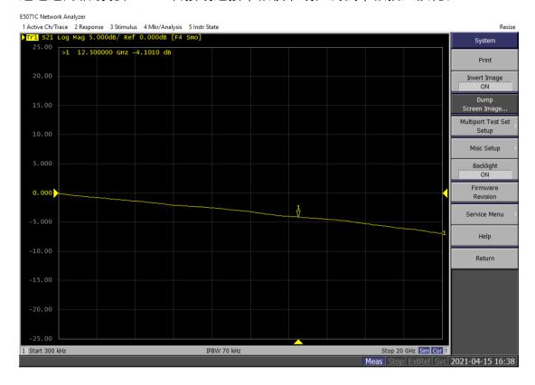
经测试, 走线 20G 带宽内无谐振, 测试结果为走线双倍线长的插入损耗, 大概是-4.0db, 实际走线信号损耗大概为-2.0db。
