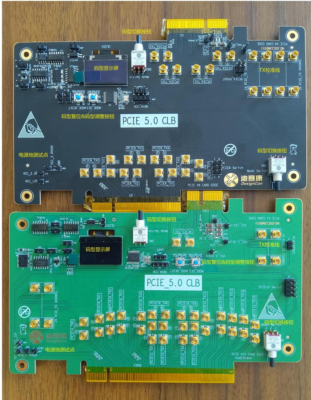
单板尺寸均满足 PCIe 标准板卡的半长全高尺寸，PCIe 信号全部走微带线，无打孔，阻抗设计控制差分 85 欧姆，包含 1 倍和 2 倍校准线。采用高速 SMP
