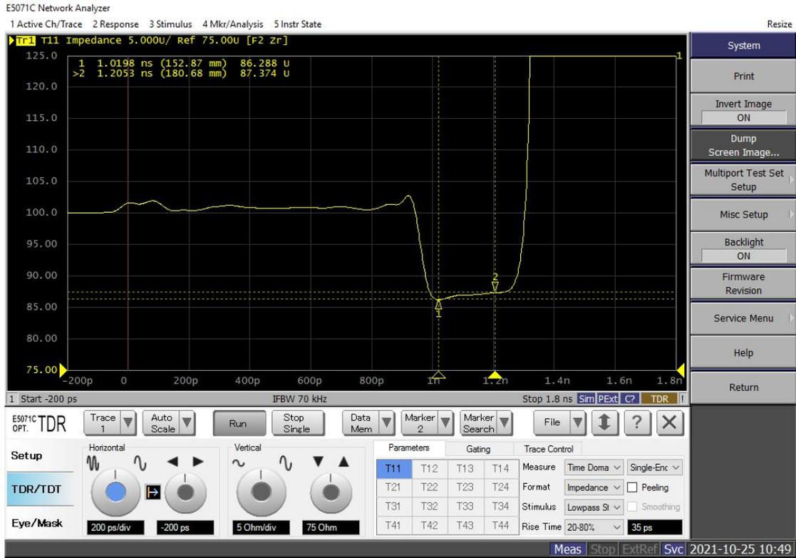
经网络分析仪测试，单板 PCIE 信号线差分阻抗均控制在  $85\Omega \pm 5\%$
