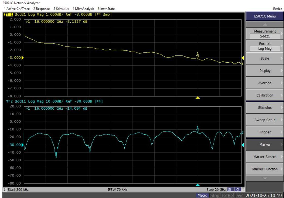
这是单倍 TX 线长的插入损耗,大概是-3.1db, 因为要减去测试线缆的损耗 1db, 所以总损耗是-2.1db (16Ghz)。
