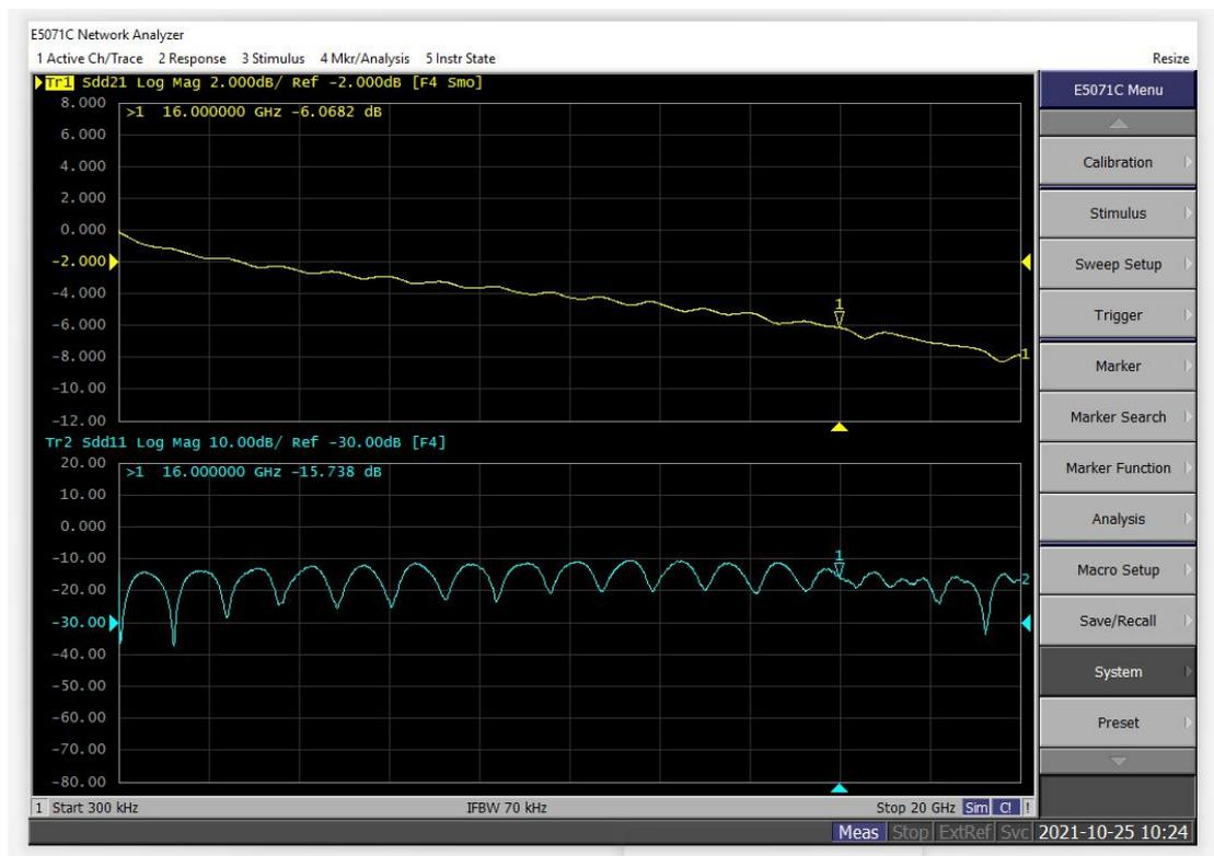
这是单倍 RX 线长的插入损耗,大概是-6db, 因为要减去测试线缆的损耗 1db, 所以总损耗是-5db (16Ghz) 。
