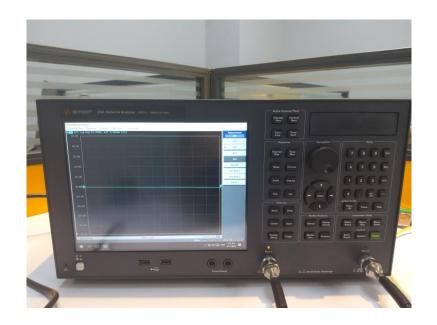
用网络分析仪测试夹具 1 倍校准线的 S11 参数和 S12 参数
